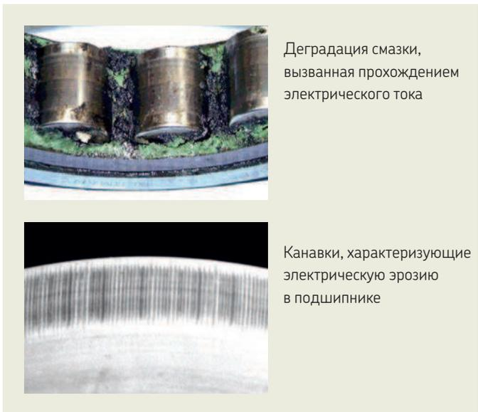
Деградация смазки, вызванная прохождением электрического тока
